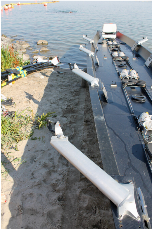
FIGUUR 3.1 De coastalroeiboot is breder, met kortere riggers
