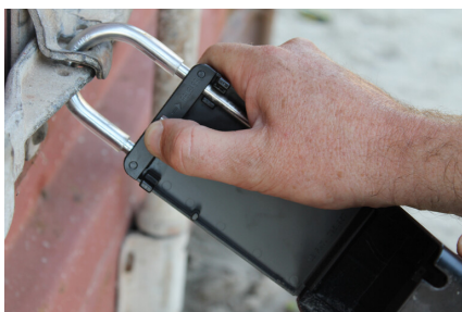
FIGUUR 8.4 Stap 3: duw het metalen schuifje opzij
