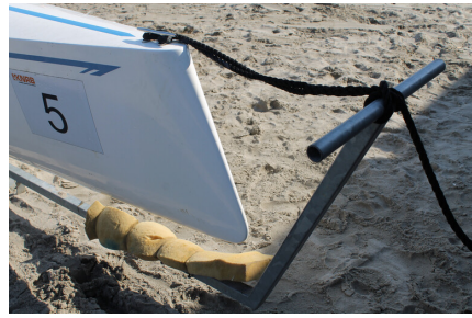
FIGUUR 4.2 Zit de boot met de landvast vast aan de trailer?
