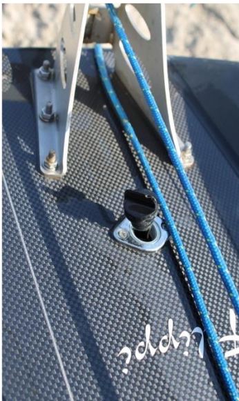
Figuur 3.3 Luchtklepje achter de stuur
