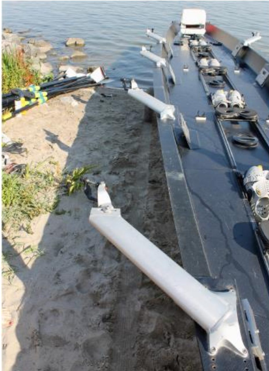
Figuur 3.1 De coastalroeiboot is breder, met kortere riggers
