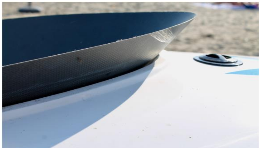
Figuur 3.4 Luchtklepje op boeg
