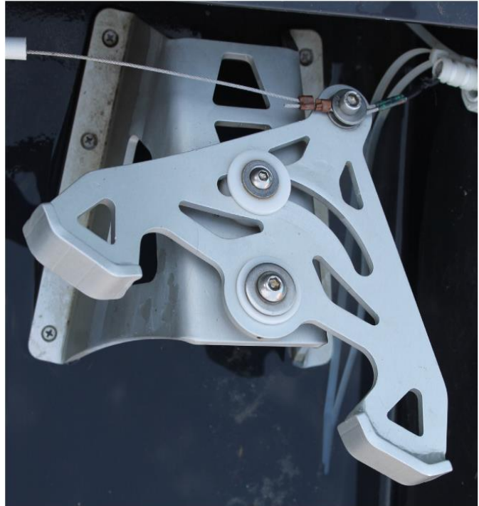
Figuur 5.1 Het stuurpedaal van de een voetgestuurde boot, zoals de Barolo
